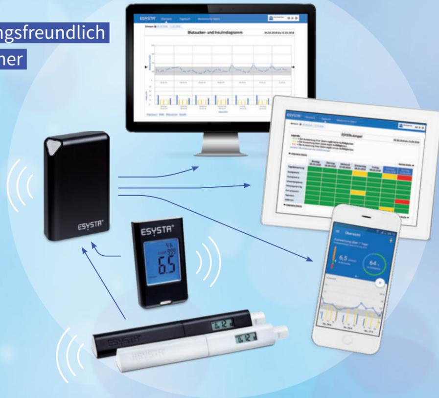
Das ESYSTA® System besteht aus den ESYSTA® Geräten, dem ESYSTA® Portal und der ESYSTA® Diabetestagebuch-App. Per kabelloser, sicherer Datenübertragung senden die ESYSTA® Geräte die aktuellen Messwerte automatisch an die ESYSTA® Diabetestagebuch-App.
